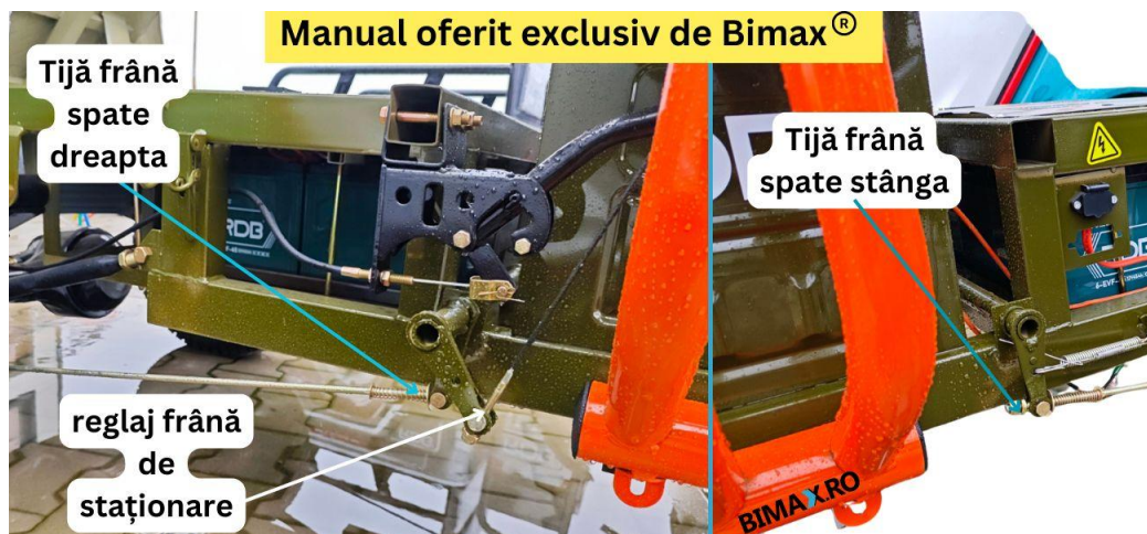
Imaginea 7 - Tijele frânelor spate si de stationare
